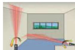
FUNCIÓN DE REPLANTEO DE DISTANCIAS CONSTANTES: Minimum or maximum distance per scanning FUNÇÃO DE REMODELAÇÃO DE DISTANCIAS CONSTANTES: distância mínima ou máxima por medição
